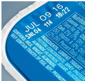
Code laser sur un opercule
